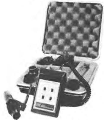
患者の一回換気量、分時換気量、累積換気量等を正確に計測することができ直ちにデジタル表示されるハンディータイプの使い易い精密計器です。
