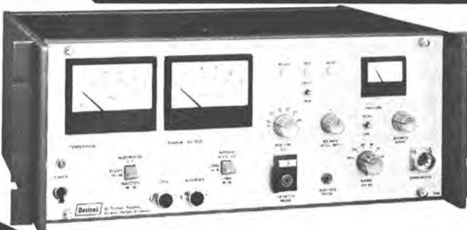
最新のサーモダイリューション法による心拍出量測定器です。
