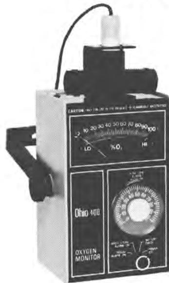
酸素テント、保育器内、レスピレーターやベンチレーター、麻酔回路中の酸素濃度を測定するコンパクトなソリッドステート回路を用いた計器です。アラーム付の200型、400型、アラーム無しの600型と用途に応じて選べます。
