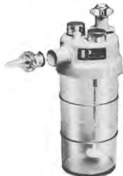
湿潤を目的とした加温式ネブライザーです。ヒーターにより体温よりやや熱めに加熱された蒸留水を噴霧して高温度の状態を作り出します。主に酸素を用いますが酸素濃度も40,70,100%の3段階に切換えられ、安全弁も付いています。
